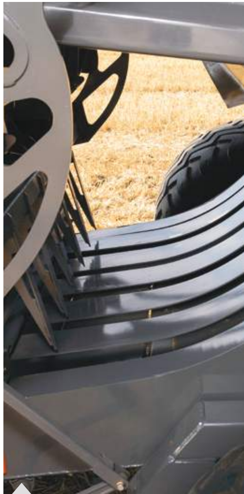
12. oldal Előtömörítő kamra
