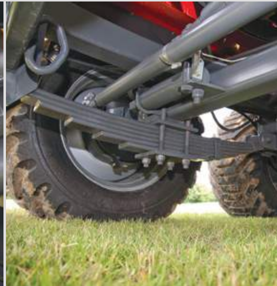
Független, laprugós felfüggesztés minden keréknél.
