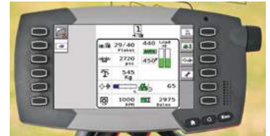
Automatikus tömörségszabályozás a C1000 bálázómonitor segítségével.
