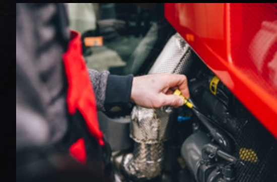
A mellő híd és a „karcúsított” motorháztető kialakításának köszönhetően az olajsínt-ellenőrző nívópálca és a szűrő is könnyen hozzáférhető.
