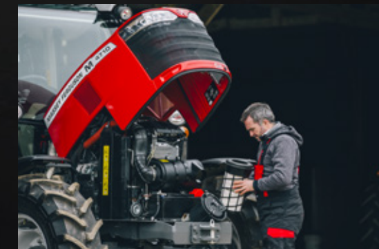
A motor légszűrője könnyen hozzáférhető és tisztítható.
